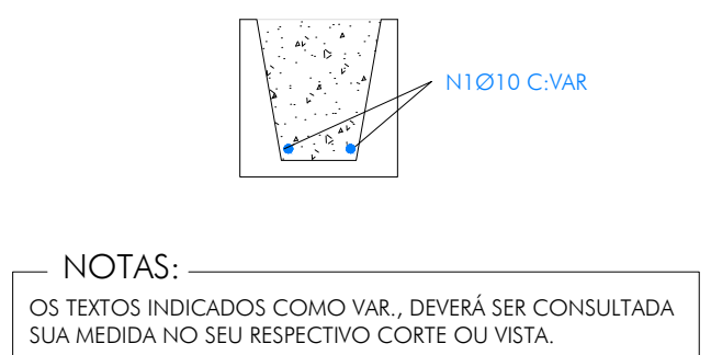
07 DETALHE - CINTA DE AMARRAÇÃO ESCALA 1:10
